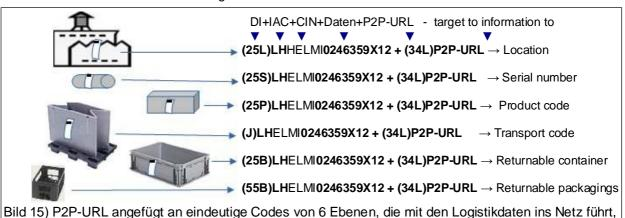
Die P2P-Lösung ist bereits Teil spezifischer Standards für AIDC-Applikationen, z.B. im DIN 66277 Elektronisches Typenschild. Dabei komplettiert "P2P" die Funktionalität der 2d+RFID-Hybridlösung mit Link auf die dem Typenschild zugehörige Internetadresse, wo die Objekt-relevanten Informationen liegen. Auch im aktuellen Entwurf für die Überarbeitung der "IEC 62090 PRODUCT PACKAGE LABELS FOR ELECTRONIC COMPONENTS USING BAR CODE AND TWO-DIMENSIONAL SYMBOLOGIES" wurde "P2P" eingefügt.
