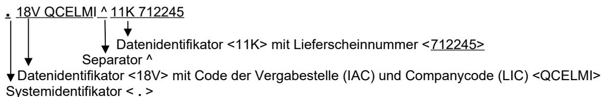
In dieser Form wird der Datenstring in einen Barcode oder in RFID untergebracht und auch gelesen:
