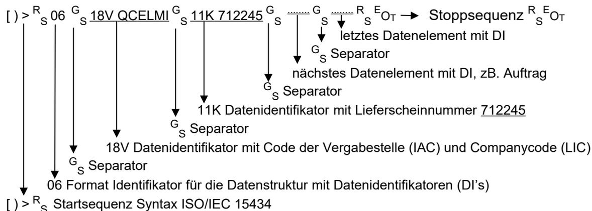
In dieser Form wird der Datenstring in einen 2D-Code oder in RFID untergebracht.
